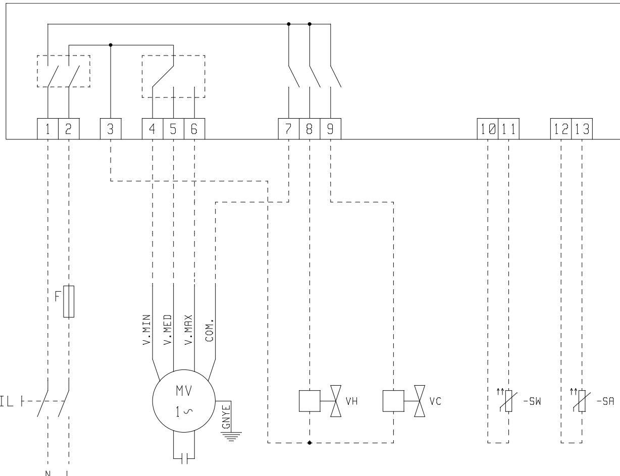
... Collegamenti elettrici a cura dell'installatore // ... Wirings made by supplier // ... Branchements électriques incombant à l'installateur //
