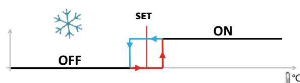
» 7 - Consenso acqua alla ventilazione / 7 - Water enabling to ventilation / Validation eau pour ventilation / 7 - Wasser zur Belüftung einwilligen / 7 - Autorización para enviar agua a la ventilación
